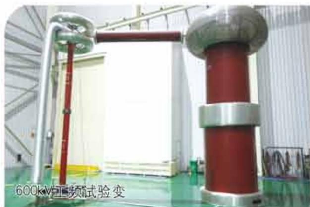
600kV工频试验变
